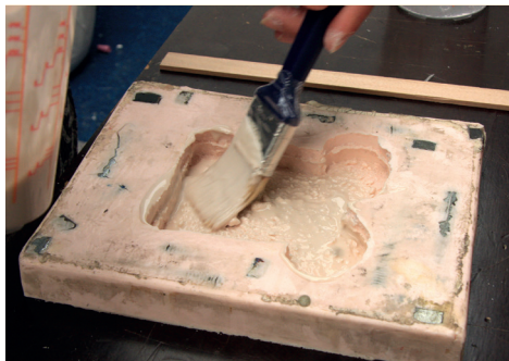
Εφαρμόστε το Α1 με πινέλο μέσα στο καλούπι ώστε να "πάει" σε όλα τα σημεία (εγκοπές)
