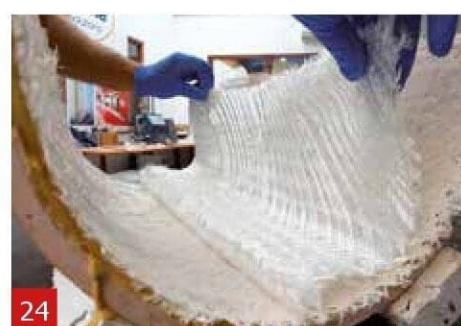
Τοποθετήστε άλλη μια στρώση υαλοϋφάσματος triaxial. Επαναλάβετε τα βήματα **22** και **23** μέχρι μέχρι να γίνουν 4 οι στρώσεις υαλοϋφάσματος. Όταν τελειώσετε καθαρίστε το πινέλο με νερό.
