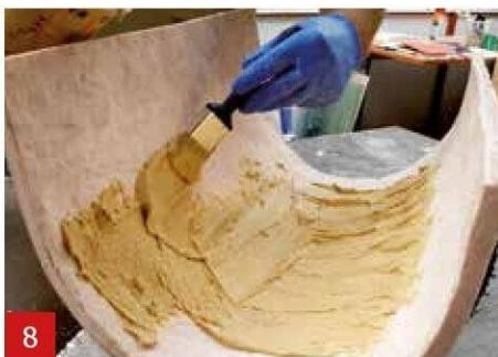
Χρησιμοποιώντας το Thix A, το A1 γίνεται πιο παχύρρευστο σαν gelcoat με αποτέλεσμα το A1 να μην ρέει σε κάθετες επιφάνειες.
