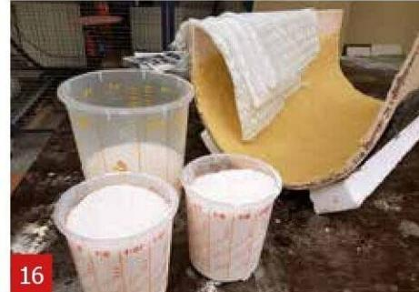
Στο μεταξύ ζυγίστε 450gr A1 ρητίνη και 900gr A1 σκόνη. Επίσης κόψτε 4 τεμάχια υαλοϋφάσματος triaxial ίδιου μεγέθους με το καλούπι που χρησιμοποιούτε.
